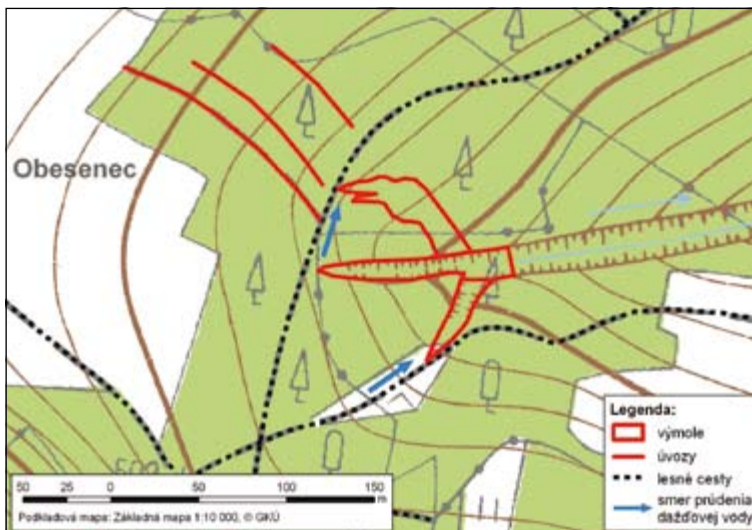
Obr. 6 Synergetický efekt cestnej a výmoľovej erózie v lokalite Obesenec
