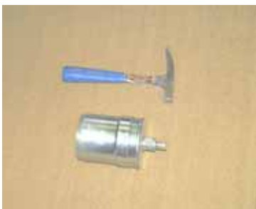
Pohľad na zložený aplikátor pripravený na odber pôdných vzoriek v neporušenom stave
