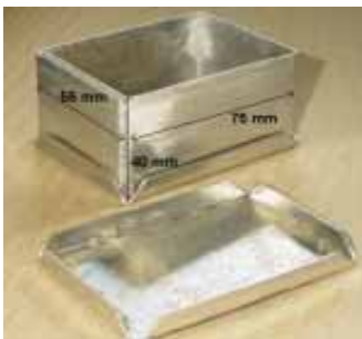
Plechovka na odber pôdných vzoriek v neporušenom stave podľa Kubiena
