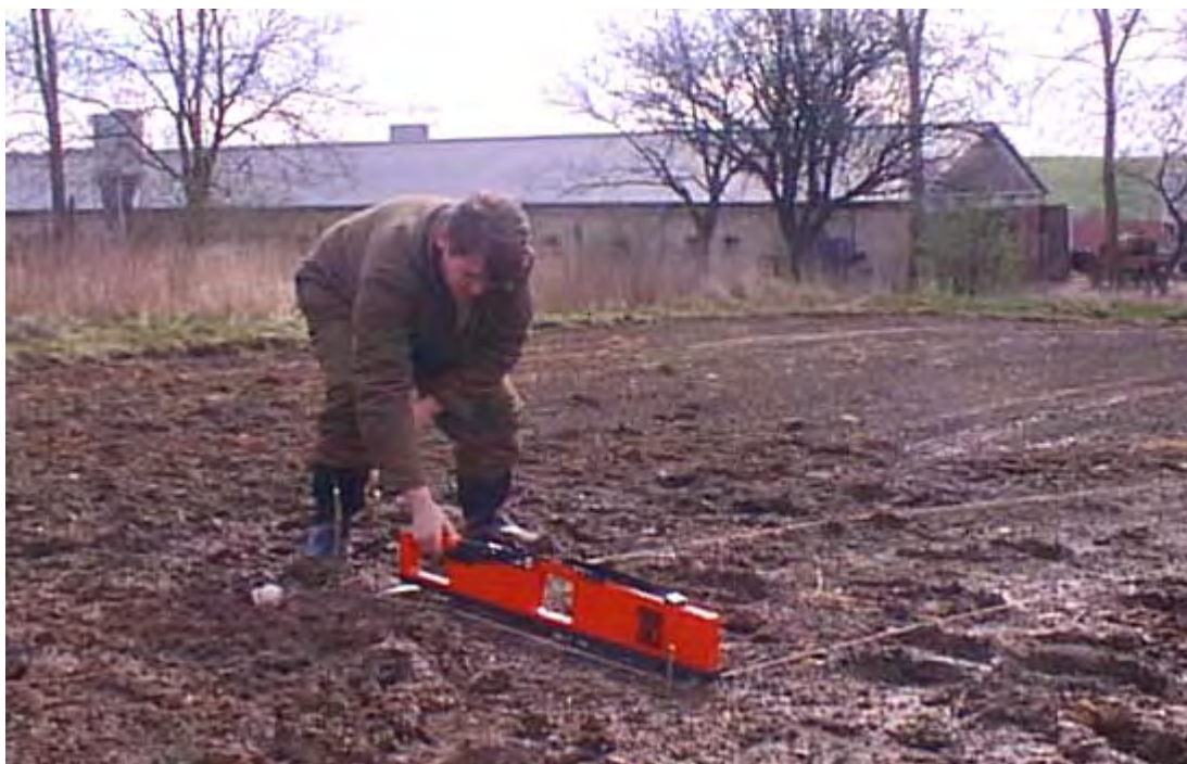
Obr. 9 Distribúcia pôdnych značiek po realizácii orby do hĺbky 20 cm po spádnici v smere dole svahom – sklon 5 °
