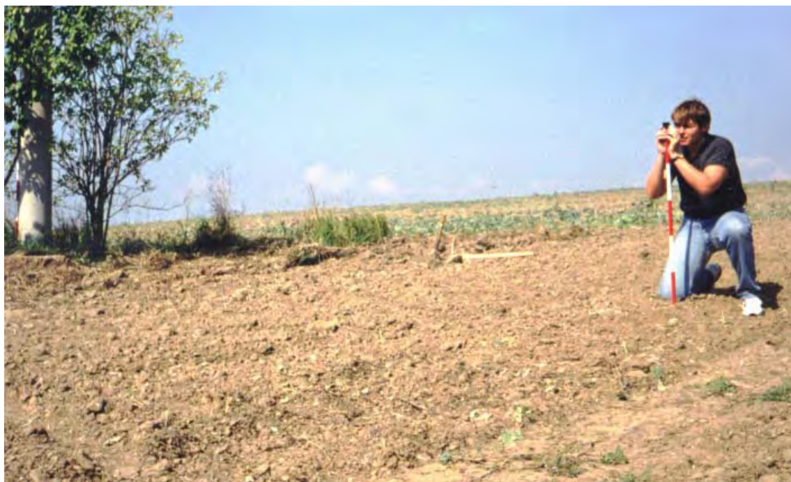
Obr. 5 Zameranie polohy inštalácie značiek pomocou optického päťbokého hranolu pravouhlou metódou
