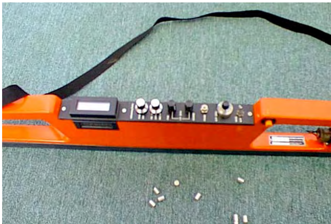
Obr. 2 Namerané hodnoty sa priamo odčítajú na LCD displeji prístroja (dole duralové značky)
