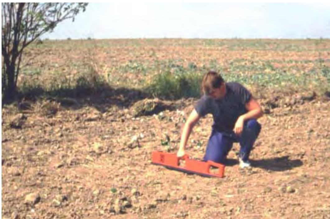
Obr. 7 Poloha značiek sa musí presne zamerať s využitím stabilných orientačných bodov v teréne
