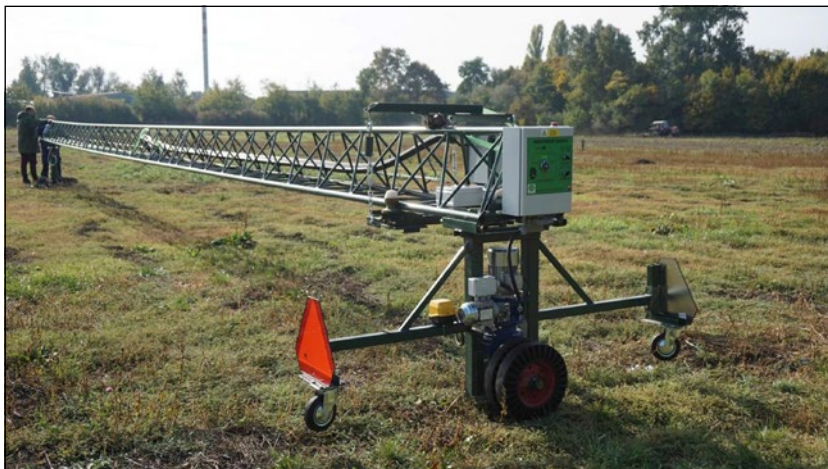
Obrázok 3 Finálna podoba konštrukcie mostového nosiča náradia
