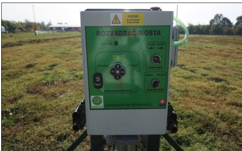
Obrázok 5 Ovládaci panel pohonu ramena mostu
