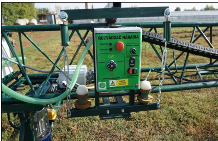
Obrázok 4 Ovládací panel pracovných náradí a pohonu mosta na „Mačke“
